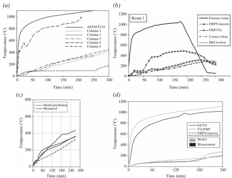
Fig. 5: Temperature evolution in FRP-strengthened (a) columns,<sup>45</sup> (b) beams,<sup>47</sup> (c) beams<sup>50</sup> and (d) slabs.<sup>53</sup>
