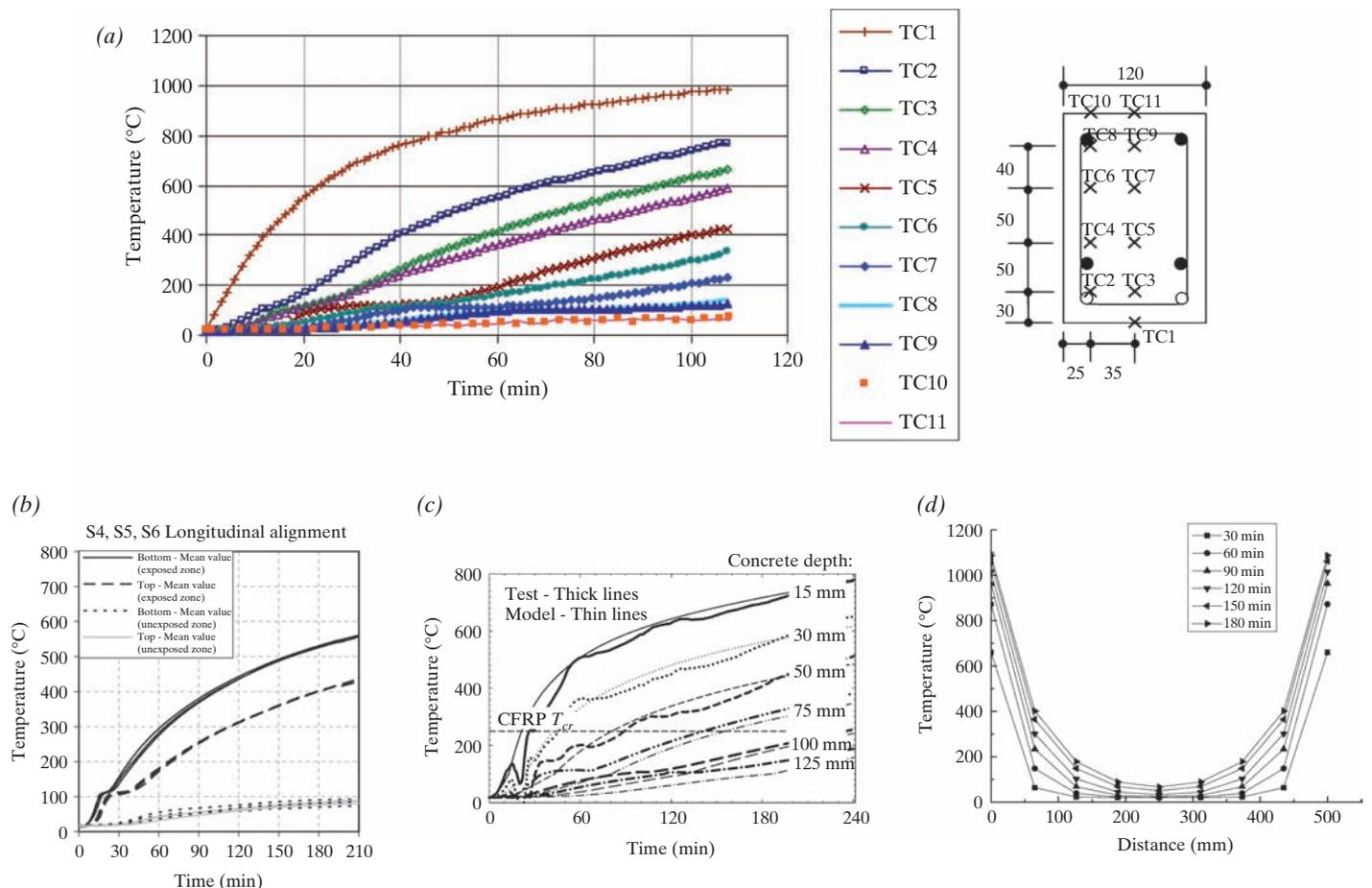
Fig. 4: Temperature evolution in FRP-reinforced (a) beams,<sup>32</sup> (b) slabs,<sup>11</sup> (c) slabs<sup>36</sup> and (d) columns<sup>38</sup>
